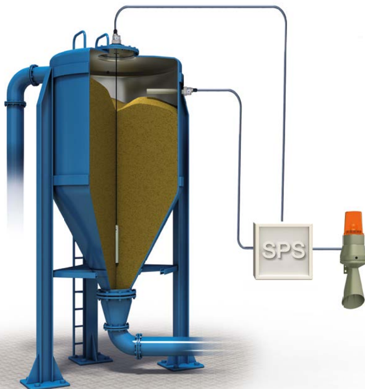
Rilevamento livelli min./max. con CapFox® ENT 21. Semplice taratura per il fluido con un perno magnetico.
