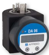
Indicatore digitale a incastro DA 06 per trasduttore di misura da 4 – 20 mA uscita e spina ISO 4400 o M12 x 1
