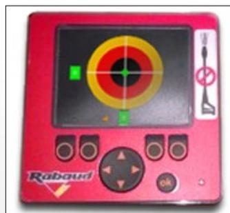
**Inclinomètre** avec niveau sur écran en cabine
