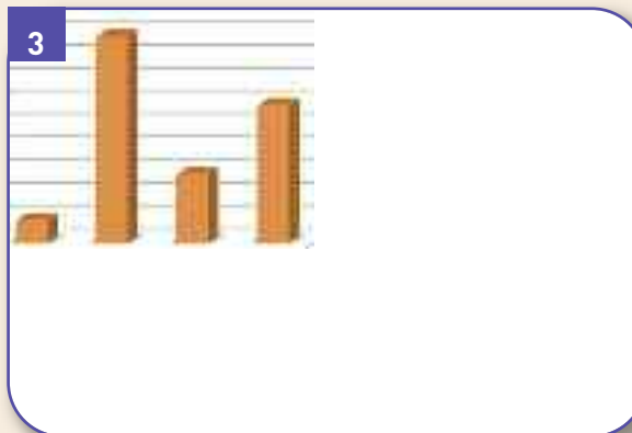
Fig. 3 : Contraintes exercées sur les piliers selon les concepts, de gauche à droite : selle disjointe, attachements rupteurs, selle semi-rigide, selle rigide.
